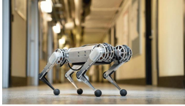
الشكل 3: حيوان الشيتا المصغر، روبوت الذكاء الاصطناعي المستقل
